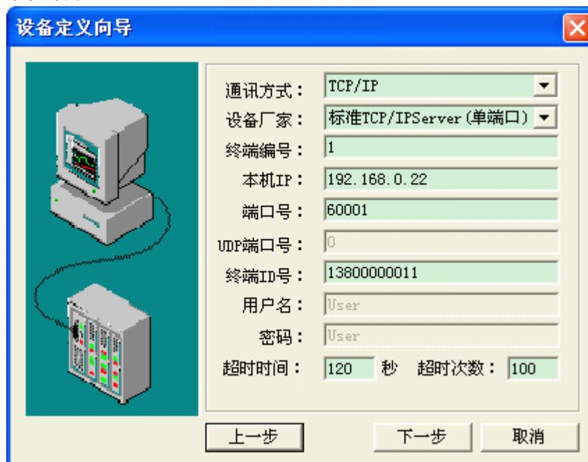
如果用一个 RTU 下，挂接多个检测设备，保持终端编号一样，手机号保持一样。
