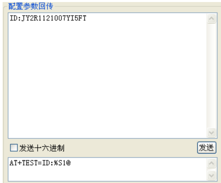
图 6-3 字符串模式下读取 ID 号
