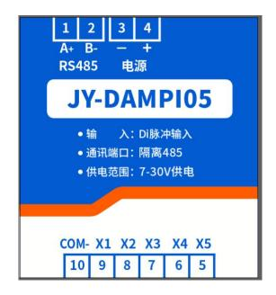
设备电源口支持 7~30V DC 输入,485 接口负责配置设备参数,COM-为脉冲输入共负端,X1~X5 为脉冲源正信号输入端。
