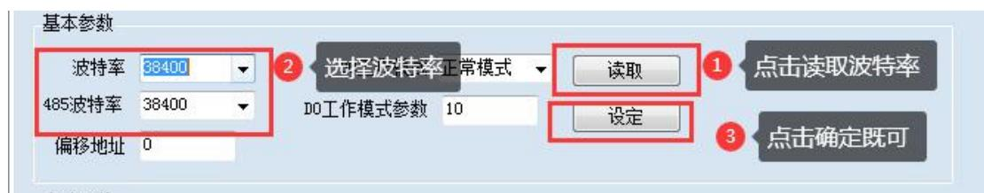
点击下方波特率设置栏的“读取”和“设置”就可以分别读取和设置波特率和地址，操作后需要重启设备和修改电脑串口设置。
