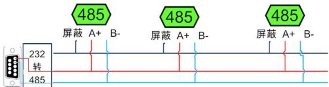
电脑自带的串口一般是 RS232，需要配 232-485 转换器（工业环境建议使用有源带隔离的转换器），转换后 RS485 为 A、B 两线，A 接板上 A 端子，B 接板上 B 端子，485 屏蔽可以接 GND。若设备比较多建议采用双绞屏蔽线，采用链型网络结构。
